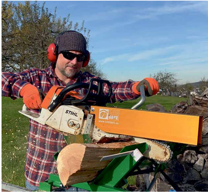
Durch die feste Verbindung der Kettensäge mit einem Sägebock und durch Abdeckungen sind die Hände bei der Arbeit mit Holz gut geschützt.
